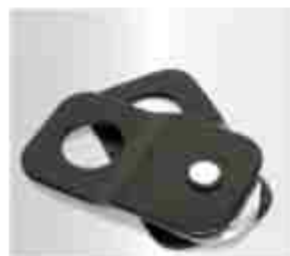
RÉF : 151 POULIE DE MOUFLAGE Permet de dévier la force et de la répartir afin de doubler la force de traction d'un treuil. » Capacité charge max : 4000 kg » Diamètre de la poulie : 54 mm
