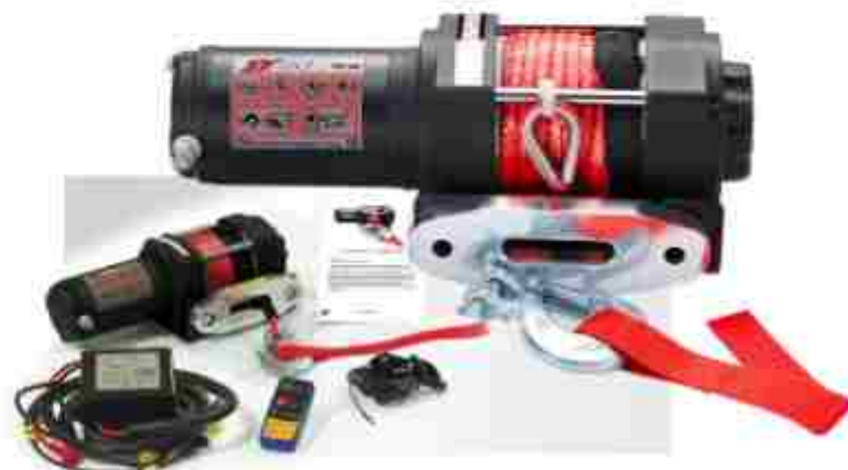
RÉF : 662 TREUIL QUAD NYLON » Commande au guidon ou télécommande sans fil » Traction : 1360 kg / Poids : 8 kg » Beaucoup plus léger qu'un treuil à câble acier, 2kg de moins » Grande longévité en utilisation difficile (eau, sable, boue, sel) » Boîtier de contrôle étanche en 12V » Câble nylon synthétique de diamètre 4,8mm et de 13m de long » Embrayage à glissement, verrouillable avec poignée latérale » Dimensions : 215 x 105 x 105 mm
