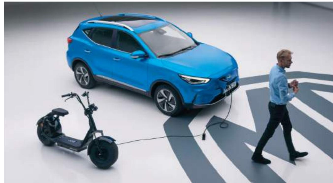
La fonction de recharge inversée V2L (Vehicle-to-Load) prolonge l'utilité de la batterie du véhicule. Branchez des appareils externes tels qu'un barbecue électrique, une glacière ou un vélo électrique et alimentez-les à partir de la batterie de la voiture (câble en accessoires). En d'autres termes, votre nouveau MG ZS EV fait également office de centrale électrique portable.
